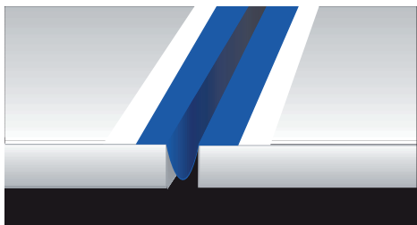
Umiestnenie pásky Mapeband do dilatlačnej škáry.
